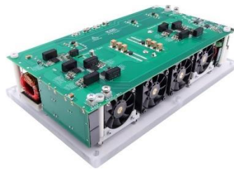
30 kW、SiC ベースの多様形式対応型 DC/DC コンバータのリファレンス デザイン
