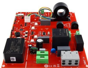
家庭用の単相 AC EV 充電器のリファレンス デザイン
