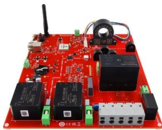
商用の三相 AC 充電器のリファレンス デザイン(OCPP 対応、Wi-Fi® SoC 搭載)
