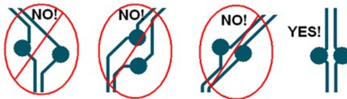
図 3-3. 差動ペアの構造に対する配置
