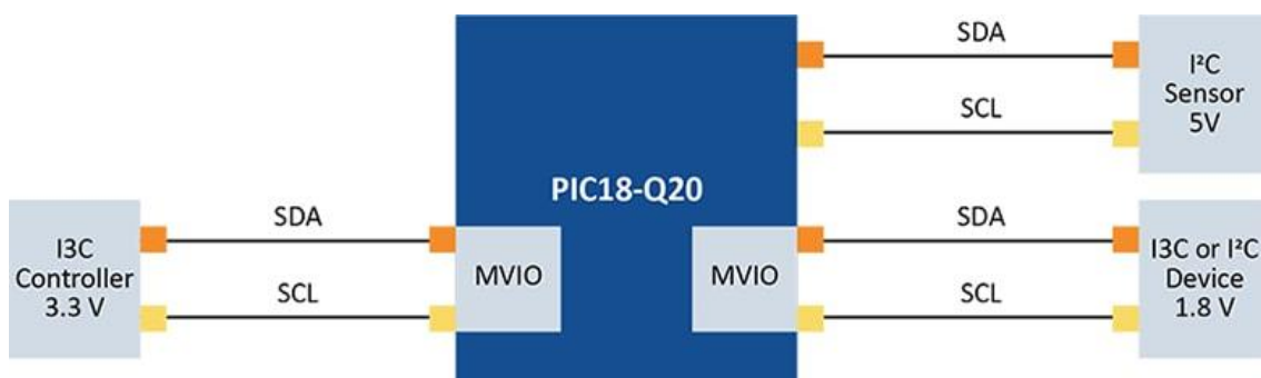
図 3: オンチップ レベルシフタ(MVIO)を使った複数電圧領域を示すバスポロジ
